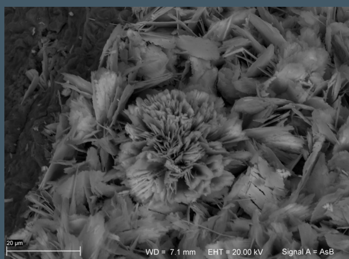
Zdjęcie elektronowe (SEI) agregatów kryształów borżękitu.
