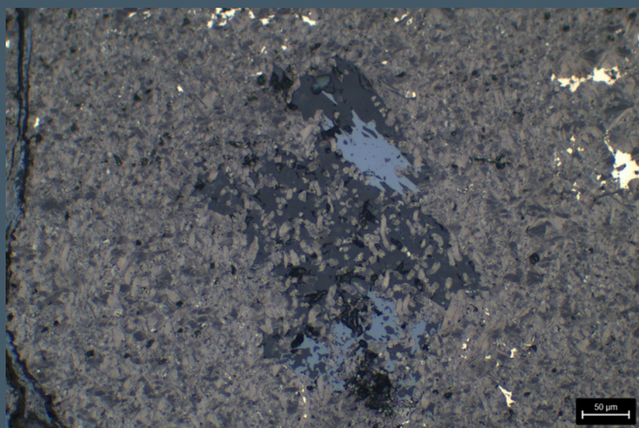
Fig. 2. Jasno-szare ziarna kopernikitu we fluorapatycie (ciemno-szare) w grafitowej strefie z wrostkami troilitu (jasne). Światło odbite.
